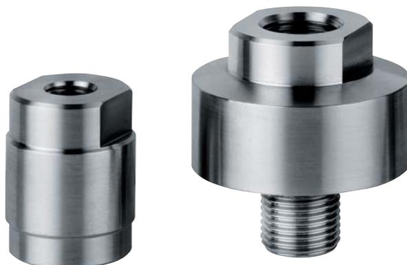
Projetados para isolar o manômetro e transmissor de pressão do fluido do processo corrosivo, viscoso e sedimentoso. Uma membrana soldada e sobreposta a prova de vedação garante a separação do fluido de transmissão do processo. As conexões roscadas nos permitem o uso em todas as aplicações onde é importante a redução dimensional e onde são necessários instrumentos com diâmetro 63 mm.
